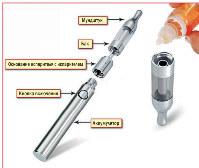
Рис. 1. Схема устройства ЭС [Устройство и виды электронных сигарет: URL: https://zdorovnet.ru/elektronnye-sigarety/ustroystvo-elektronnyh-sigaret.html . (Дата обращения: 11.01.2022)] / Diagram of the electronic cigarette device [Device and types of electronic cigarettes: URL: https://zdorovnet.ru/elektronnye-sigarety/ustroystvo-elektronnyh-sigaret.html . (Accessed: 11.01.2022)]
